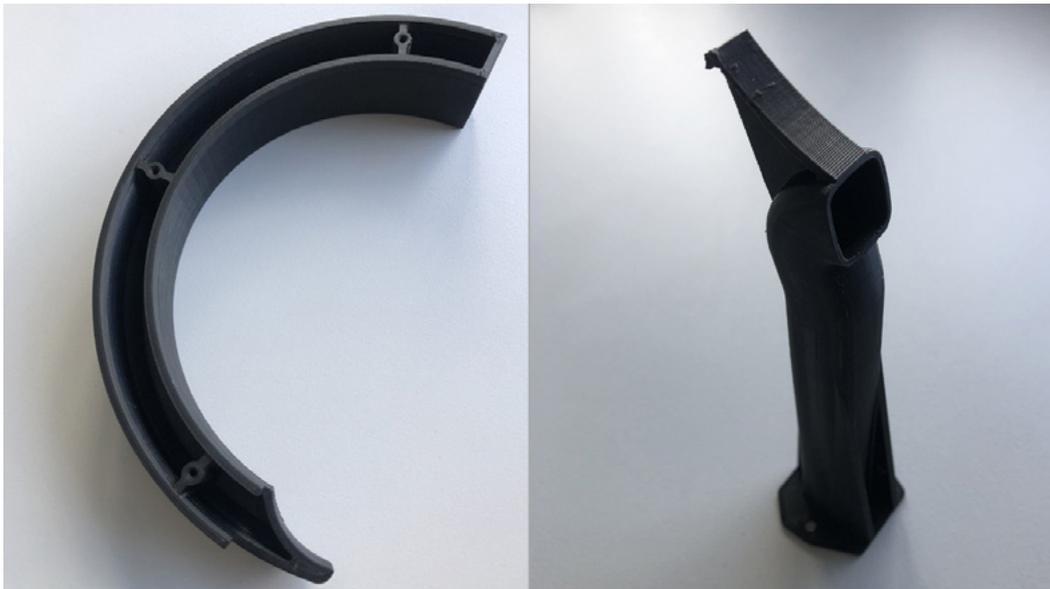
*Die Stütze (links) und der Blasluftfinger sind klassische Beispiele, wie 3D-Druck bei Müller Martini genutzt wird. Die Prototypen wurden im 3D-Druck hergestellt, die Serienteile indes werden im Kunststoffspritzverfahren hergestellt. Sie kommen in Sammelheftern zum Einsatz.*
