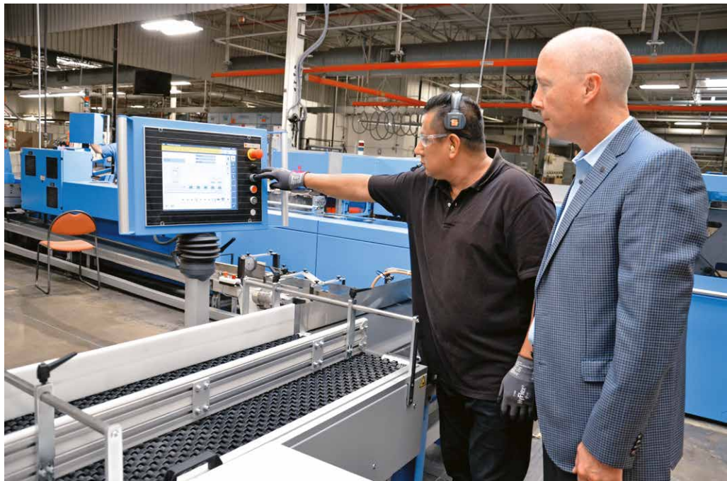
Israel Bonfil (Maschinenführer bei Core Publishing Solutions), mit Eric Olsen (Sales Manager Müller Martini North America) an der Bogenstapel-Zuführung für digital gedruckte Produkte, die in Eagan als Spezialkonstruktion zwischen der Zusammentragmaschine und dem Klebebinder Alegro Digital platziert ist.
